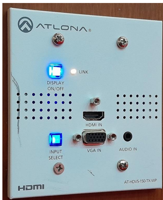
รูปจุดเชื่อมต่อสัญญาณภาพเพื่อไปฉายภาพออกจอโปรเจ็คเตอร์
