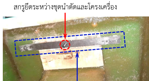
วัสดุยึดสกรูแทนน็อตตัวเมีย ที่ติดตั้งได้โครงเครื่อง
